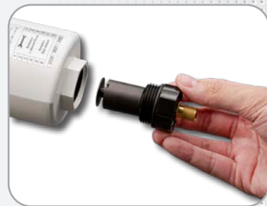
Purgeur automatique et passe-cloison aluminium. Dépose par l'extérieur du filtre (PNX 120 et sup.). Racc. taraudé pour purgeur.: 1/2" pour PNX 50 et 90 1/2" (ou 1" si dépose adaptateur) PNX 120 et sup.
