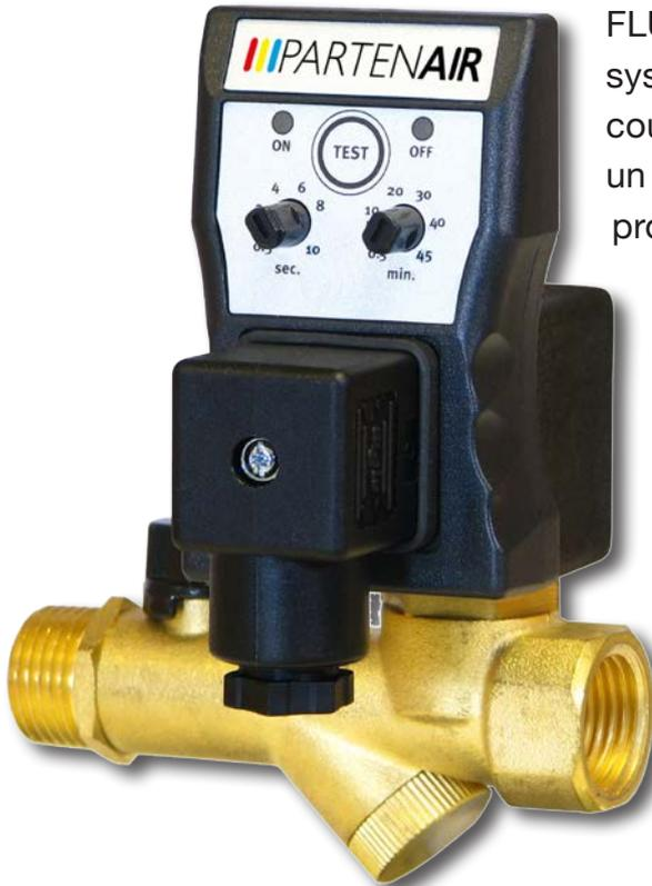
FLUIDRAIN® COMBO évacue les condensats des systèmes d'air comprimé au moyen d'une électrovanne couplée à un programmateur électronique réglable et à un ingénieux système compact muni d'une crépine de protection et d'une vanne d'isolement.
